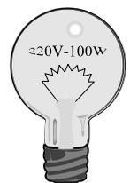
**15.** En algunos circuitos eléctricos se coloca un fusible que consiste en un trozo de hilo conductor de unas características tales que cuando la corriente que pasa por él supera cierto valor éste hilo se quema (funde) con lo que se interrumpe el paso de la corriente. Supongamos que al lado de un enchufe (220 V) encuentras un fusible con la inscripción  $I = 10 \text{ A}$ . ¿Podrías conectar a ese enchufe una estufa eléctrica de 2500 W?
